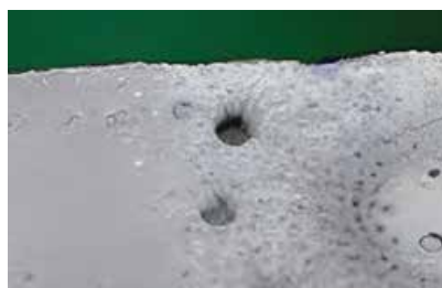
Другой сайдинг под микроскопом 200x
